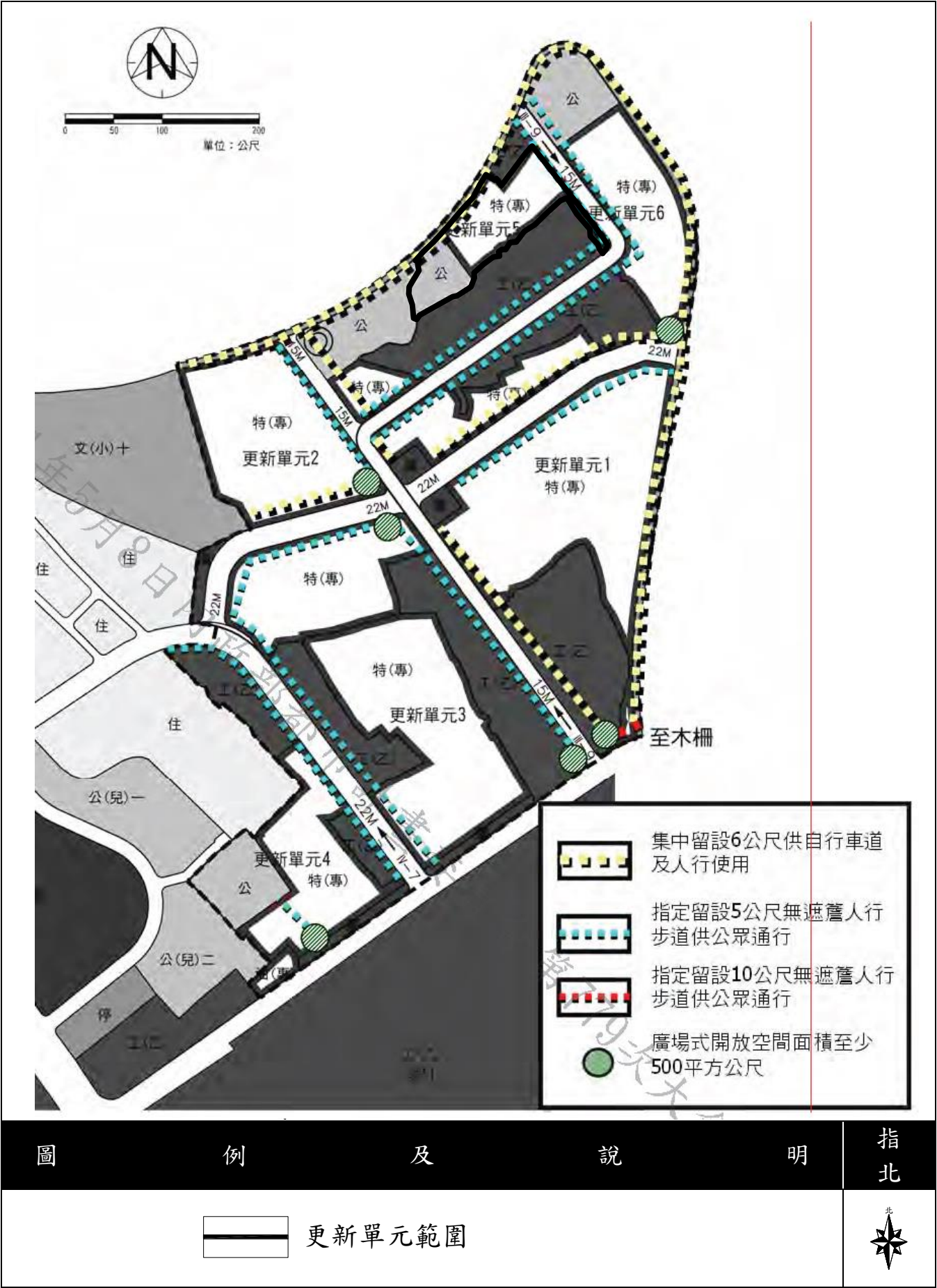
圖 6-14 建築量體相關退縮及開放空間留設規定示意圖
